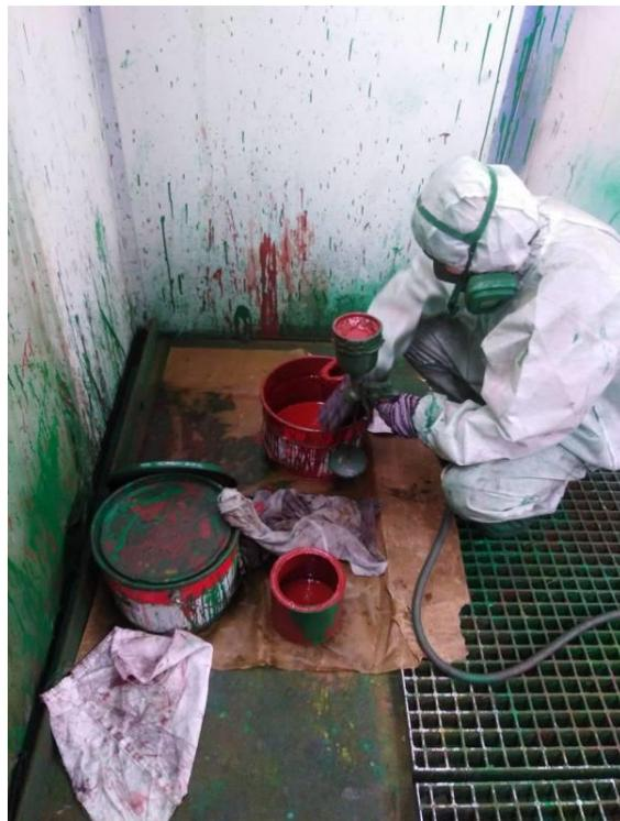
*Переливание или розлив лакокрасочного материала из бочек, бидонов и другой тары весом более 10 кг не механизированы, переливание из одной тары в другую производится не на поддоне с бортами не ниже 50 мм*
